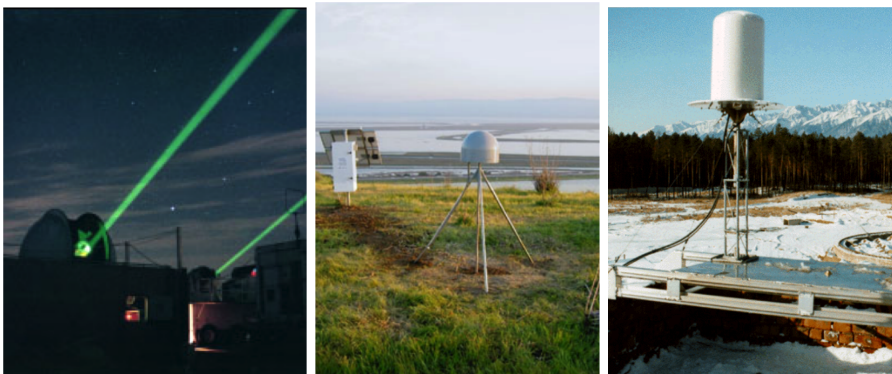
FIGURE 2.20 – Gauche : station SLR à Greenbelt (USA, Maryland), avec deux tirs laser dans le vert. Centre : station GPS permanente en Alaska. L'antenne, montée sur un trépied métallique ancré dans la roche, est protégée d'un radome. Le boîtier en arrière-plan contient le récepteur GPS, son alimentation et le système de communication pour le transfert des données. Droite : base DORIS à Badary, Sibérie. Il s'agit d'un dispositif émetteur vers des récepteurs embarqués sur divers satellites.
