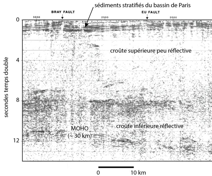
FIGURE 1.11 – Profil de sismique réflexion au travers du bassin de Paris (expérience ECORS, Marthelot et Bano, 1990).
