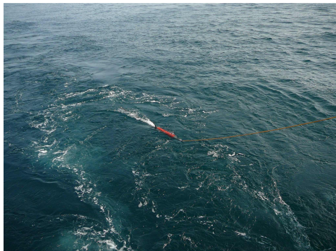
Figure 9 – Magnétomètre de queue de flûte sismique
