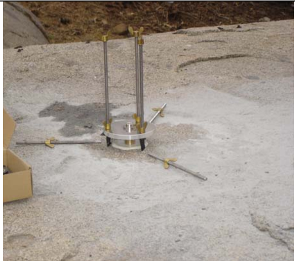
Séchage : Le repère est maintenu vertical pendant le séchage grâce à la plaque bullée.
