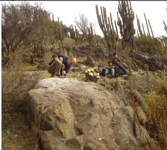
Collage : Le repère géodésique est mis en place et collé dans le trou à l'aide d'une colle spéciale bi-composant à séchage rapide
