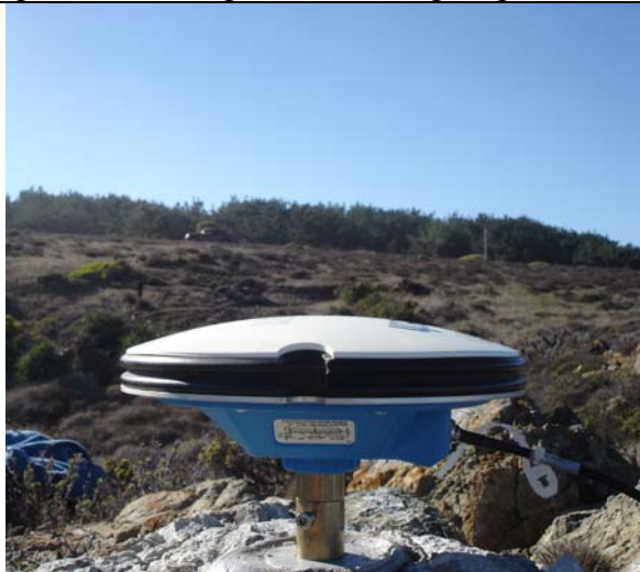
La mesure : l'antenne GPS est boulonnée directement sur le repère géodésique au moyen d'un adaptateur standard
