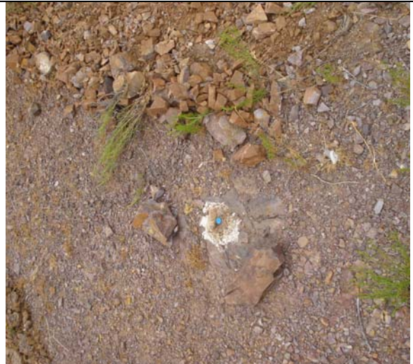
Camouflage : après la mesure, le pas de vis du marqueur est protégé par un bouchon et l'ensemble dissimulé... jusqu'à la prochaine fois
