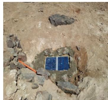
**Photo12:** Inclinométrie HMBCX, ajout d'un panneau de 12w.
