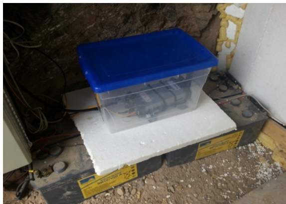
Illustration 8: Le GPS NetR9 a été mis dans boîte plastique et posé sur les batteries de la station.
