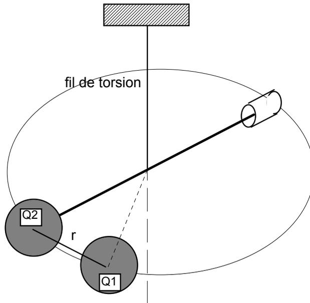
Comme dans l'expérience de Cavendish pour la gravité, chacune des charge exerce une répulsion sur l'autre, ce qui provoque une rotation du pendule. Il suffit de mesurer la rotation de la "balance de Coulomb" pour en déduire la force d'interaction des deux charges...
