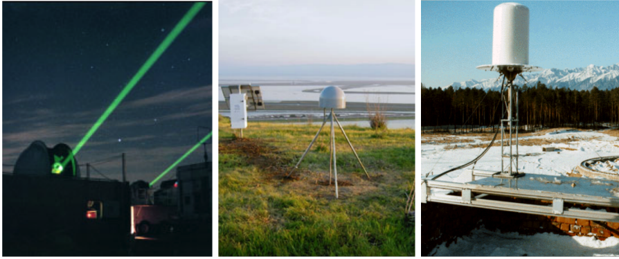
FIGURE 2.25 – Gauche : station SLR à Greenbelt (USA, Maryland), avec deux tirs laser dans le vert. Centre : station GPS permanente en Alaska. L’antenne, montée sur un trépied métallique ancré dans la roche, est protégée d’un radome. Le boîtier en arrière-plan contient le récepteur GPS, son alimentation et le système de communication pour le transfert des données. Droite : base DORIS à Badary, Sibérie. Il s’agit d’un dispositif émetteur vers des récepteurs embarqués sur divers satellites.
